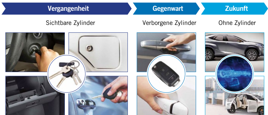
BILD 2 Vergangenheit und Gegenwart: Zukünftig werden Pkw ohne mechanische Schließzylinder auskommen (© Kiekert)
