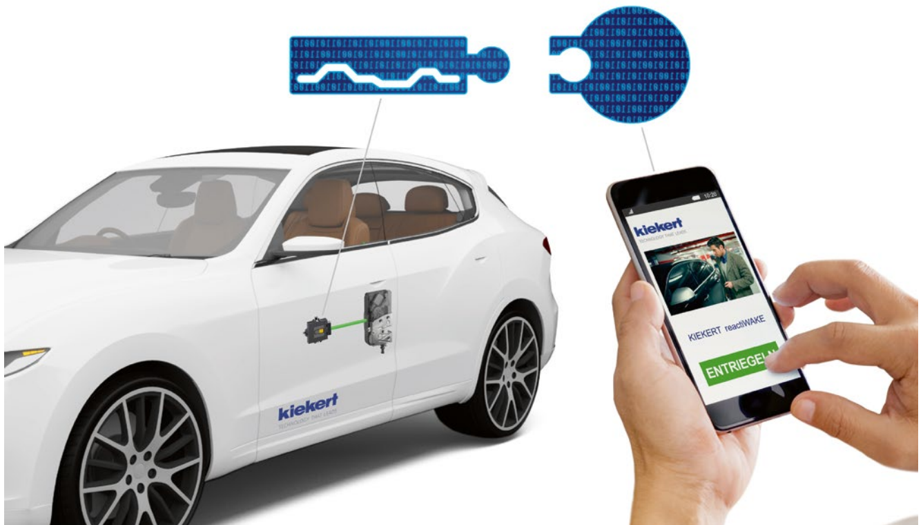
BILD 3 Die Aufteilung des digitalen Schlüssels auf das ReactiWake-Steuerg r in der T r und das Smartphone in der Hand (  Kiekerk)
