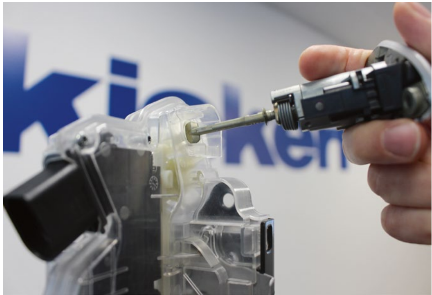
BILD 1 Die mechanische Verbindung zwischen Schließzylinder und Schloss erfordert deren räumliche Nähe (© Kiekert)
